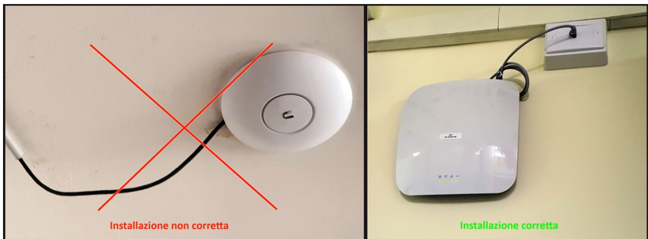
Figura 10 – Installazione corretta dell'Access Point
